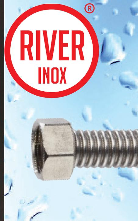
Longitud extensible al 100% de la longitud de suministro gracias al tratamiento térmico efectuado a la tubería. Tubo corrugado de acero inoxidable AISI 316L de espiras paralelas Racores de acero inoxidable soldados a la tubería, con dos planos para acople de llave anti-torsión (evita la torsión de la tubería al apretar la tuerca giratoria) Juntas de estanqueidad incluidas, en fibra verde para agua.
